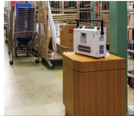
膨大な備品を保管する備品庫には高濃度オゾンガス発生器を配置し、倉庫内全域をオゾンで除菌を行う。物品の清拭を省略し拭き漏れを防ぐ。写真の機材は救急隊が導入している「BT-088」の民生機版「オラくりん」大相撲九州場所が開催される福岡国際センターの備品庫にも同様の機材が導入され、イベント開催時にはフル稼働している。
