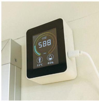
オゾンを発生させるLyon Ceiling (右上) オゾン濃度の測定モニター (左上) 換気状況がわかる二酸化炭素濃度計測器 (下)
