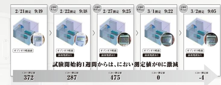
&テスト使用機器】オゾンガス発生器BT-088、ポータブル型ニオイセンサXP-329m【浮遊菌使用機器】RCSエアーサンプラー4分 160L(Biotest-Serum-Institut GmbH製)、採取菌種:室内浮遊菌一般細
